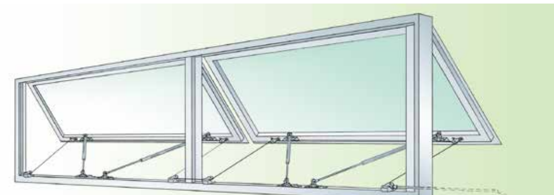
※上図は突出し窓(MD-WY)納まり
